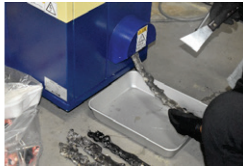
破碎、熱処理後、排出口から インゴットがでてる
